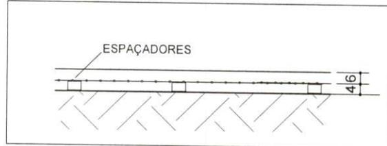
O POSICIONAMENTO DA ARMADURA DO RADIER COM A UTILIZAÇÃO DE ESPAÇADORES, PARA GARANTIR A ALTURA CORRETA
