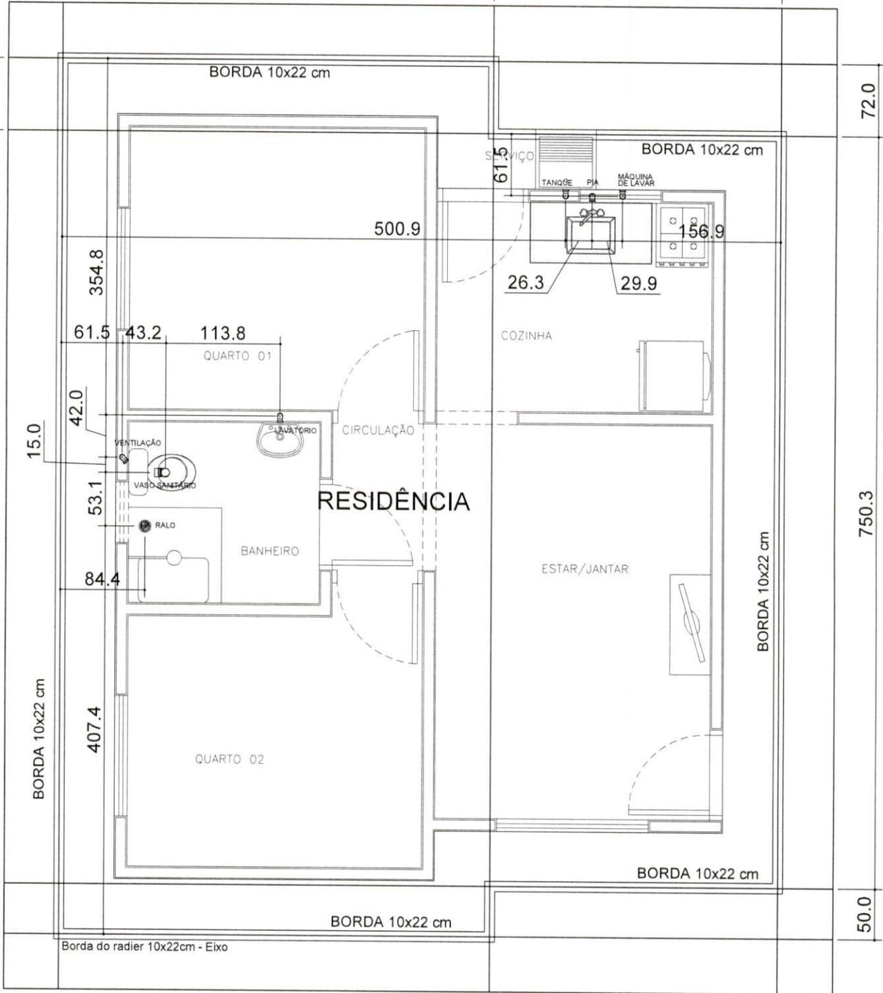
Planta de Locação do Radier - EIXO Esc.: 1/50
